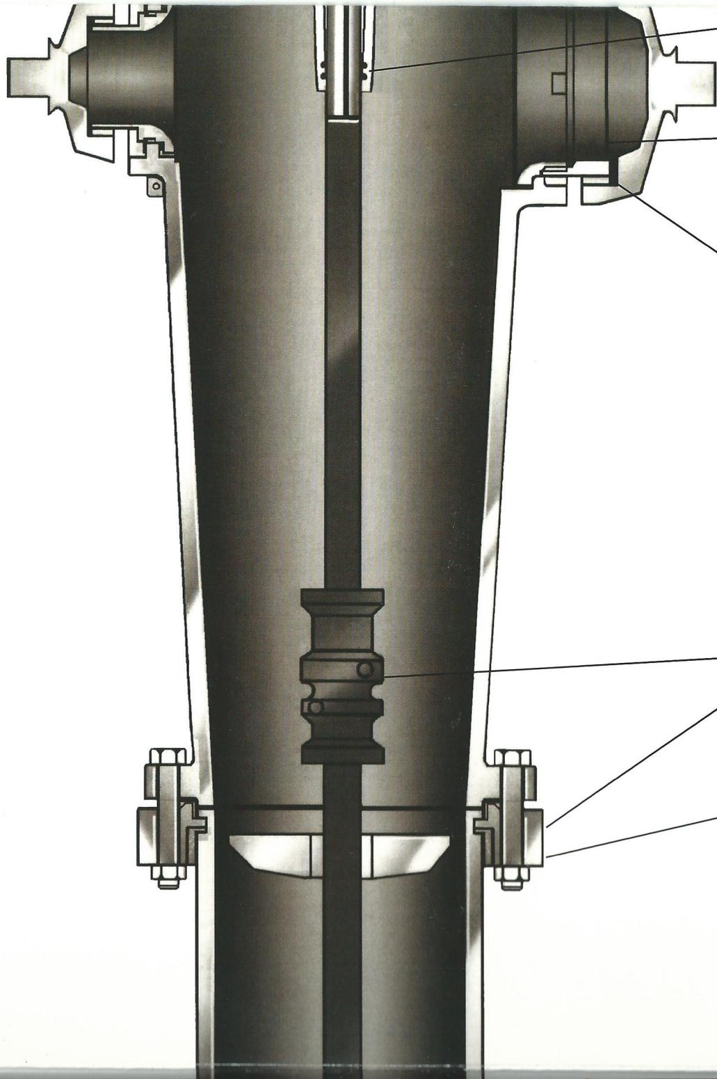
1. Les joints renforcés assurent l'étanchéité de la partie supérieure de la bouche d'incendie.
