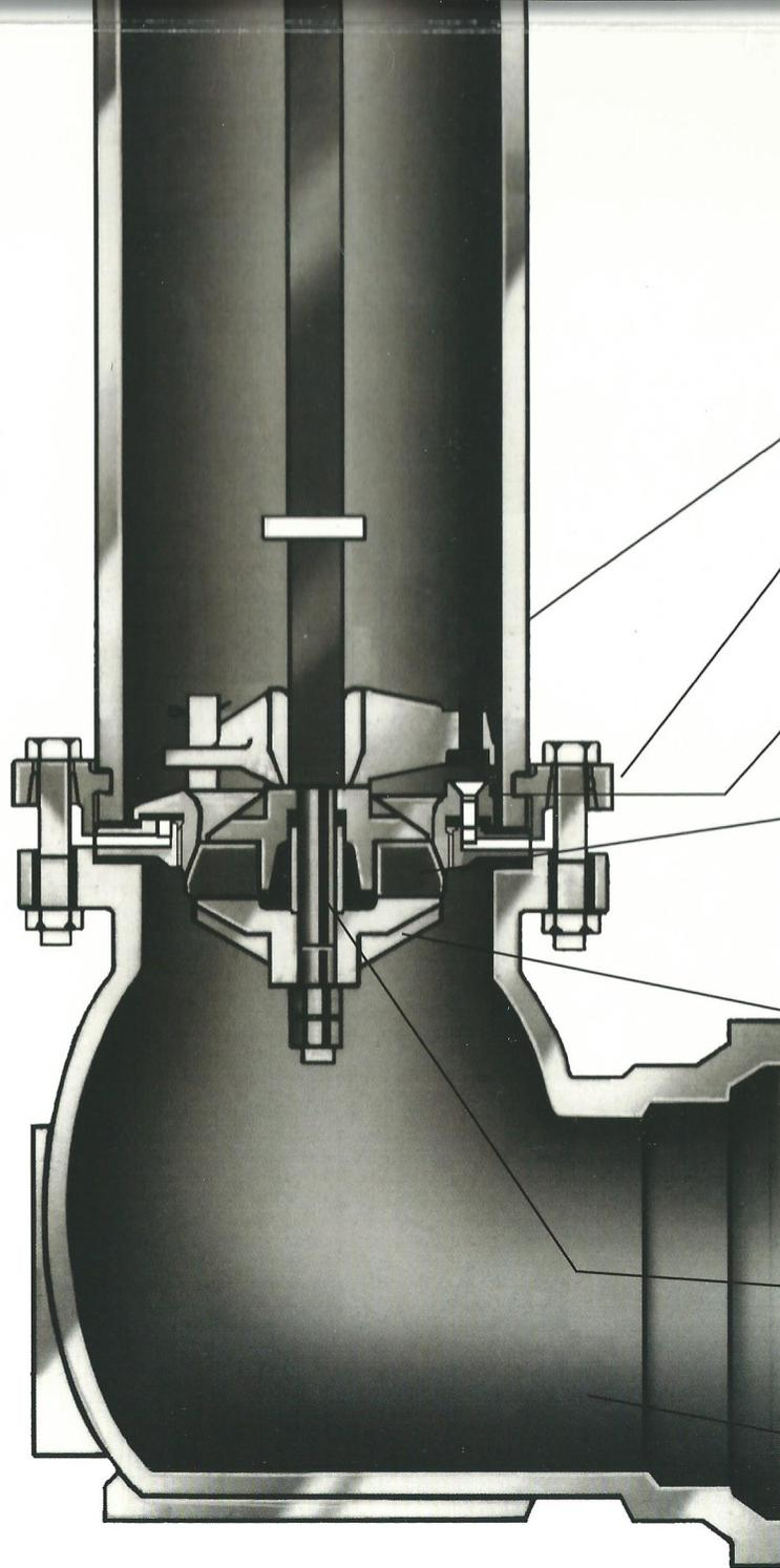
8. La colonne inférieure et la bride de jonction avec le coude sont en fonte ductile pour limiter les dommages souterrains.
