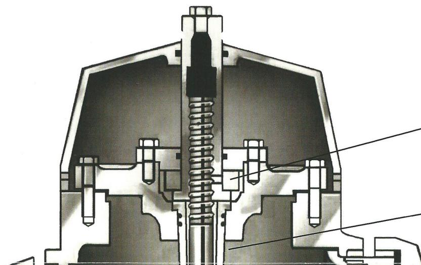
1. Palier en Delrin® permet à la noix de manoeuvre de fonctionner sur une surface lisse et à l'épreuve de la corrosion.
