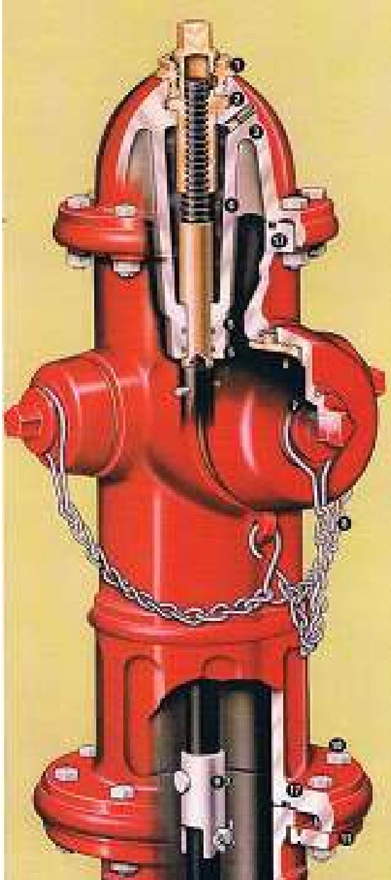
**Écrou de retenue** – il agit en tant qu'élément de protection contre les intempéries. Il prévient l'enlèvement non-autorisé de la noix d'opération. Deux joints toriques faits d'un matériel résistant à la détérioration sous l'effet du soleil empêchent l'infiltration d'eau et assurent ainsi une protection contre le gel.
